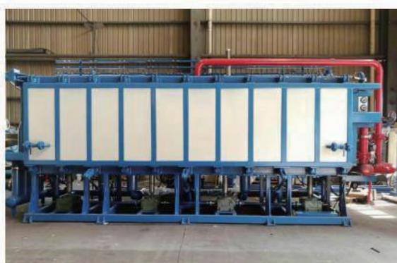
Máquina de Moldagem de Bloco
